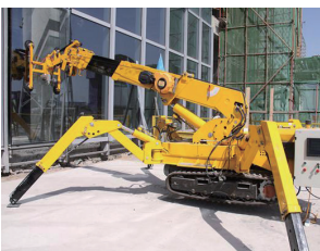
我院建筑机器人团队研发的幕墙安装机器人
